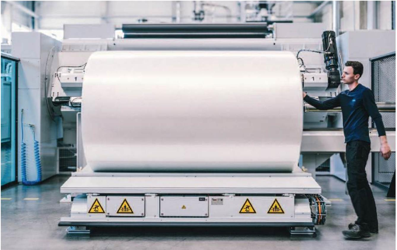
Der neue Wendewickler W1300 von SML ist mit leistungstarken technischen Funktionen ausgestattet. Seine Fähigkeit, Jumbo-Rollen mit einem mechanischen Durchmesser von 1.500 mm zu produzieren, bietet Herstellern zahlreiche Vorteile in nachgelagerten Prozessen.
