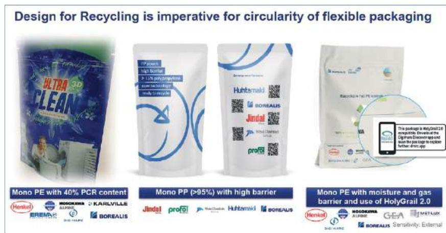
Beispiele für ein optimiertes Verpackungsdesign durch DfR (Quelle: Borealis Polyolefine GmbH)
