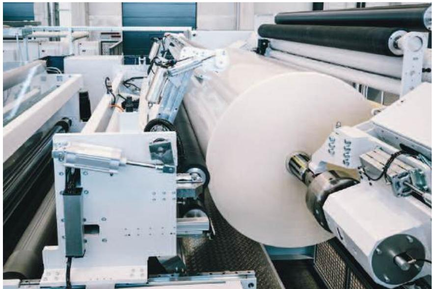
der Rolle bis zur letzten Lage in einwandfreiem Zustand zu halten. Die Nachrüstung eines Rollenhandlingsystems ist sowohl für die Wicklung ohne Welle als auch für die Wicklung mit Welle möglich. Bei Betrieb ohne Welle ist das Rollenhandling auch mit einem Brückenkran möglich.
