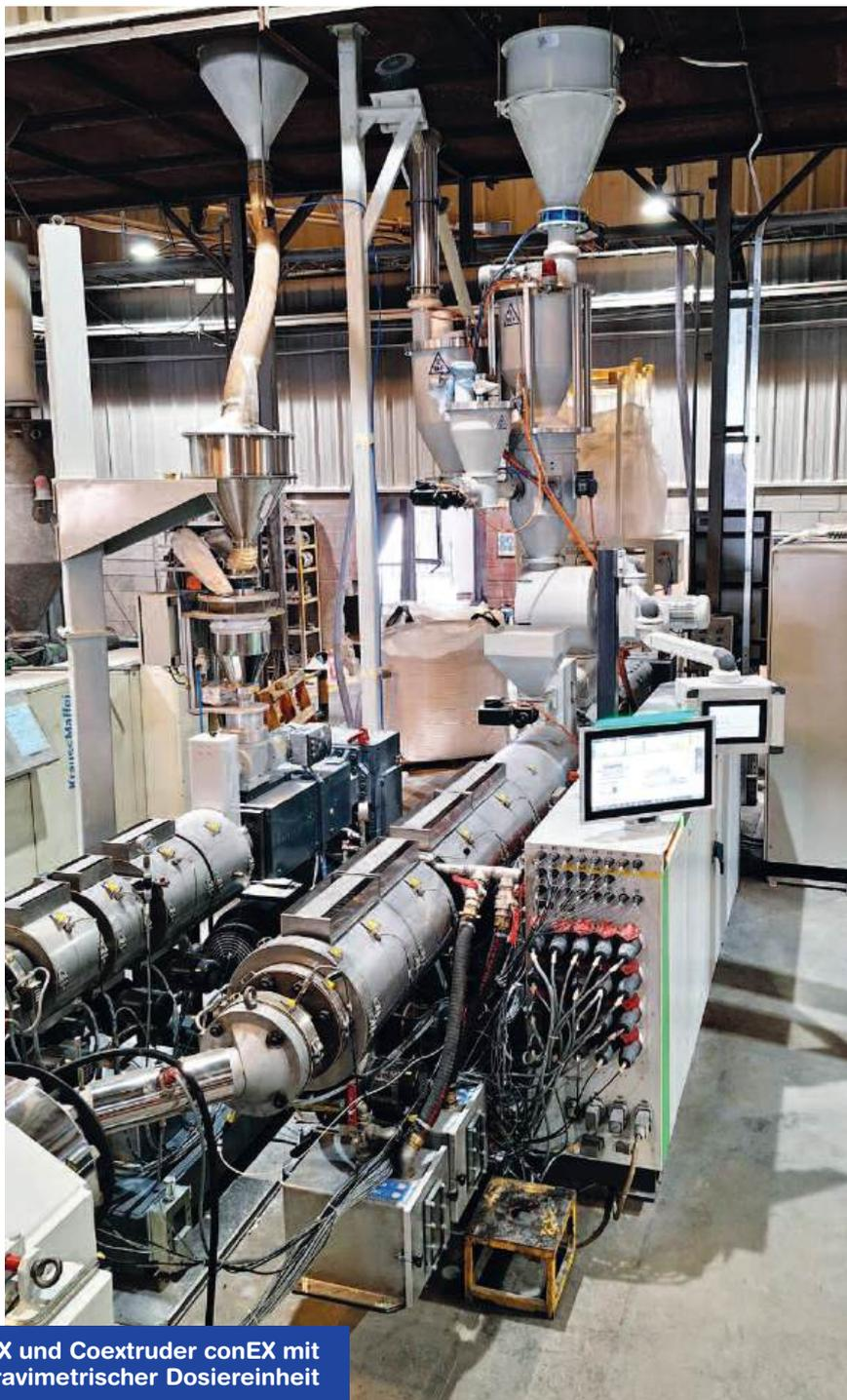
Doppelschneckenextruder twinEX und Coextruder conEX mit fest installierter gravimetrischer Dosiereinheit
