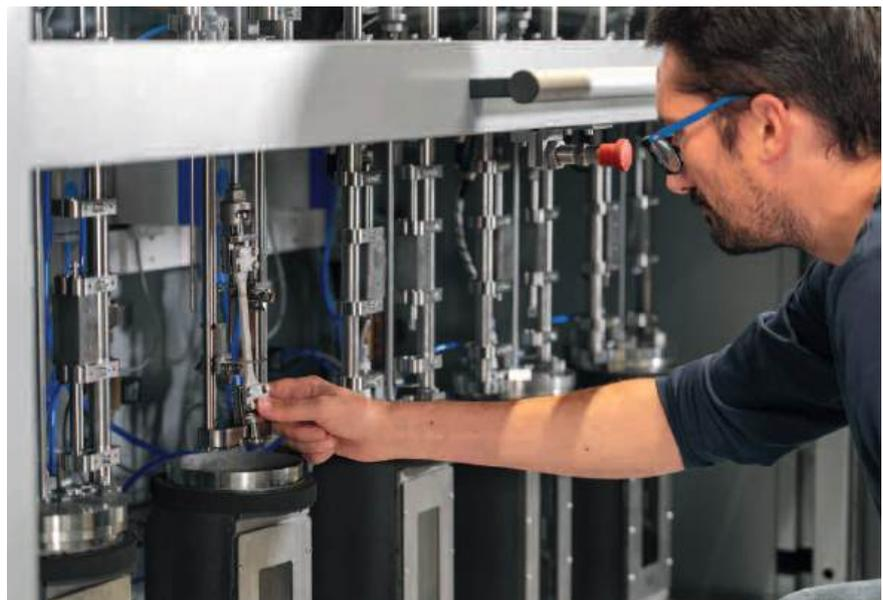
Neu entwickelte Prüfanlage (bestehend aus sechs autarken Messstationen) zur Ermittlung des Einflusses von Medien auf die Spannungsrisssbeständigkeit von Kunststoffen (Foto: Luca Hoffmannbeck/SKZ)
